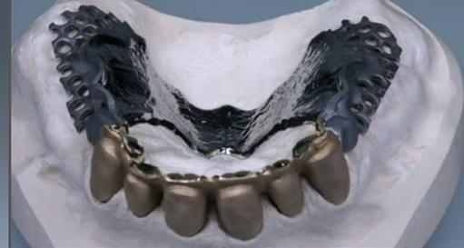
**20 - 24** Die Umsetzung in Metall erfolgte im Einstückguss. Die vorbereiteten T-Verbindungen werden dem Verfahren der Kerneinbettung folgend mit einer Einbettmassenkonzentration von 100 % eingebettet. Für das Modell wird hingegen eine Konzentration von 55 % verwendet. So erhält man ein exakt sitzendes transversales Band und eine T-Verbindung mit einem minimalen Klebespalt zur Sekundärstruktur
