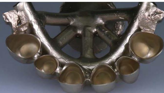
**09** Nach dem Einbetten mit einer Phosphatgebundenen Präzisions-Einbettmasse (29 : 11 ml) erfolgte die Umsetzung in Metall im Speedguss-Verfahren
