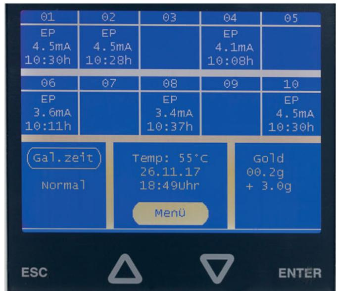
Abb. 24 und 25 Individuelle Einstellungsmöglichkeiten und Kontrolle am Galvanogerät Heliiform HF 700.
