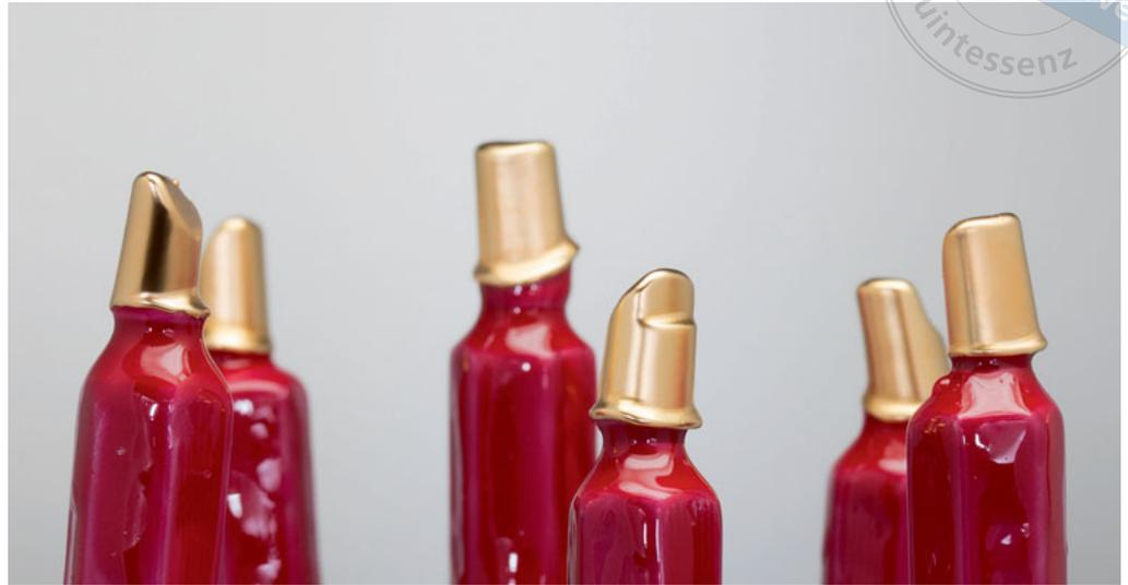
**Abb. 26** Glatte, homogene Oberflächen nach dem Galvanisieren.
