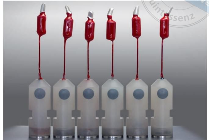
Abb. 23 Für den Galvanoprozess vorbereitet.
