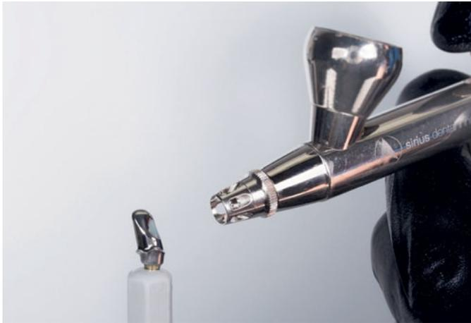
Abb. 22 Auftragen des Leitsilberlackes mit der Airbrush-Pistole.
